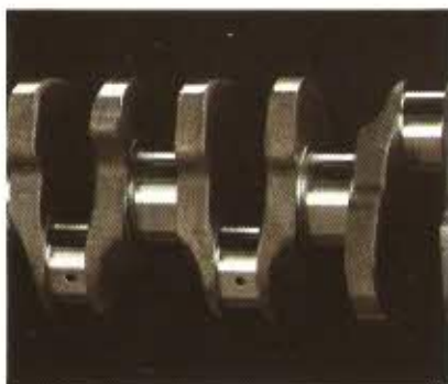
3. En helt fantastisk rolig og turbineagtig motorgang er opnået ved en meget omhyggelig konstruktion og svingningsdæmpning af krumtapakslen.
