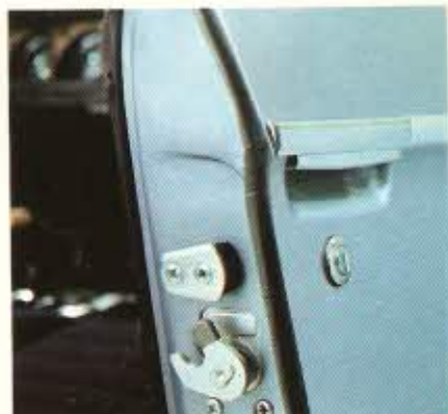
Sikkerhedsdoerlaase, der forbliver lukkede ved kollisioner
